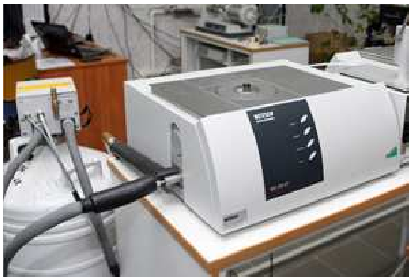
Рис. 2.5.1. Дифференциальный сканирующий калориметр "NETZSCH" DSC 204 F1 для измерения термодинамических характеристик.
