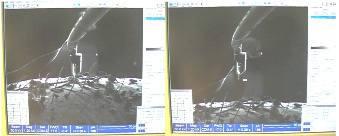
Рис. 6.2.4. Микропинцет с объектом манипулирования вблизи тельца насекомого.
