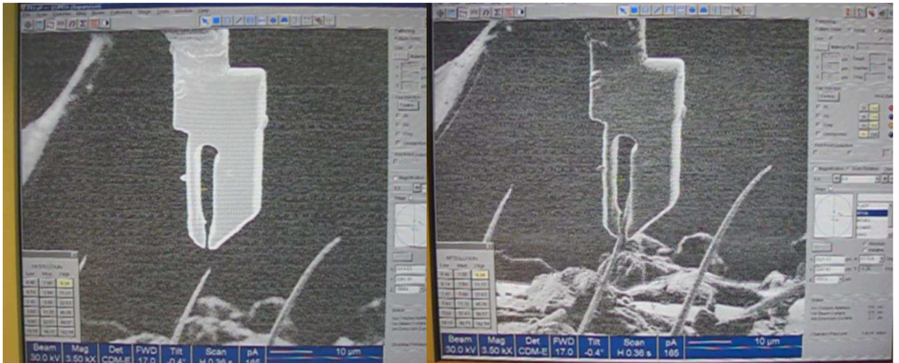
Рис. 6.2.1. Подвод объекта манипулирования в створ рабочей части микропинцета (слева), захват объекта манипулирования микропинцетом (справа).
