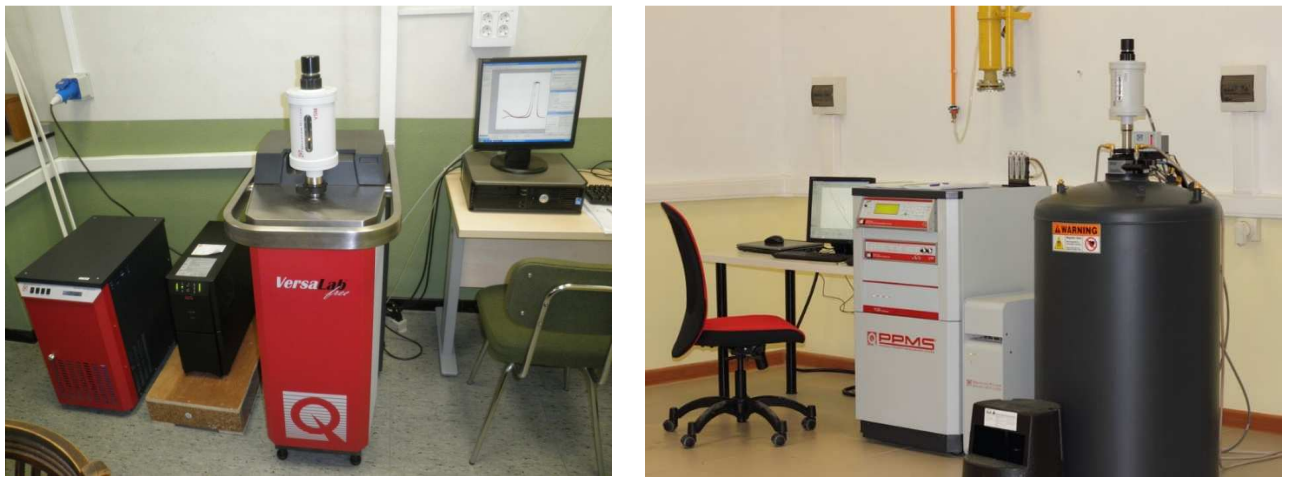
Рис. 2.3.1. Вибрационный магнитометр VersaLab фирмы «Quantum Design» (слева) и система для измерения физических свойств PPMS-9Т «Quantum Design» (справа).
