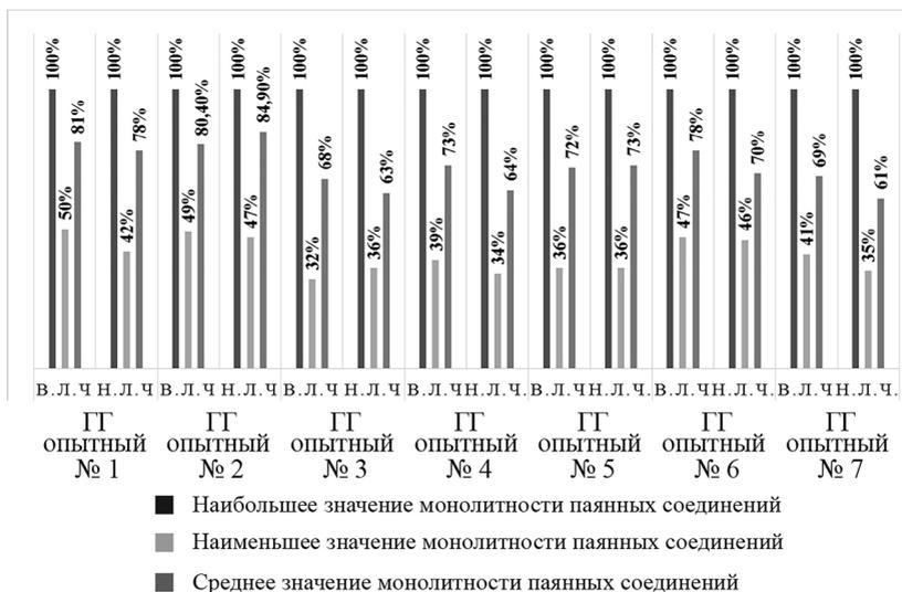
**Рис. 1.** Сравнительный анализ экстремумов и средних показаний монолитности паяных соединений обмоток статоров исследуемых гидрогенераторов
