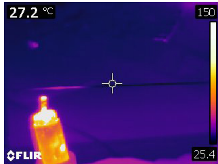
Рис. 2. (a) Схема измерительного комплекса: 1 — нагреватель; 2 — область нагрева; 3 — образец. (b) Снимок эксперимента с помощью тепловизора Flir E50.
