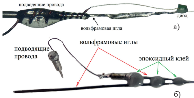
Рис. 1. Система нагрева с оптимизированной геометрией кончика (а), двухигольчатая система нагрева (б)
