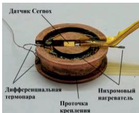
Рис. 1. Монтаж элемента контактной пары Cu-Cu
