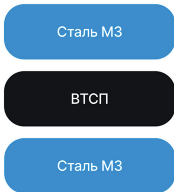
Рис. 1. Схема эксперимента по захвату магнитного потока в образцах ВТСП керамики
