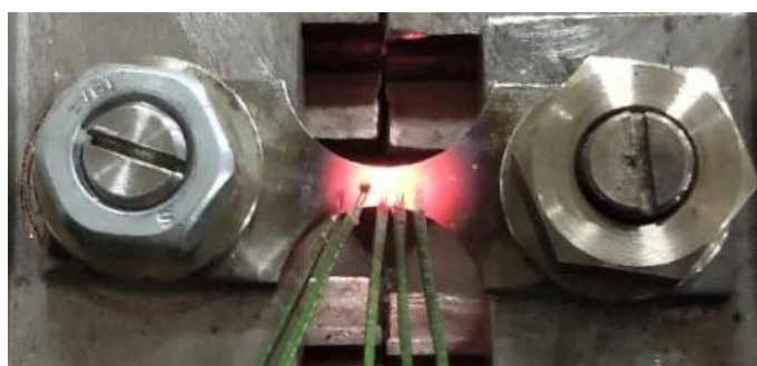
Рисунок 2 - Внешний вид корсетного образца из сплава ЖС32 во время испытания
