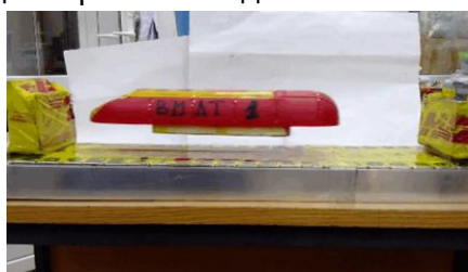
Рисунок 1 - Принцип магнитной левитации
