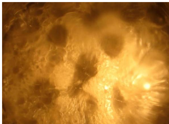
Рис. 1. Фотография «паровых столбов», наблюдавшиеся в тонком слое н-додекана при пузырьковом кипении: высота слоя h = 2.5 мм ( h/l_\sigma = 1.45 ), давление в объеме P_s = 20 кПа ( P_s / P_{cr} = 1.1 \cdot 10^{-2} ), q = 108 кВт / м 2 , (T_w - T_s) = 42.1 К.
