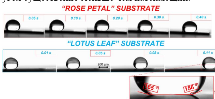
Рис. 1. Движение капли водно-глицериновой смеси 1:10 по поверхностям с различным смачиванием.
