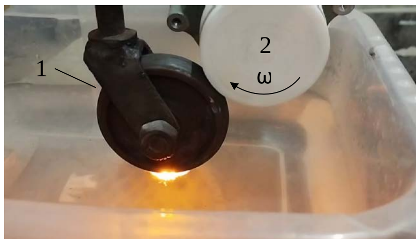
Рис.1. Закалка детали вращения в плазмотроне с жидким электродом: 1 – модель валка, 2 – привод модели валка.
