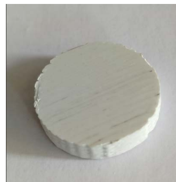
Рис.3. Образец в виде таблетки, напечатанный на FDM 3D-принтере
