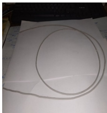
Рис. 2. Композитный пруток с содержанием 65% масс. порошкового материала Al_2O_3
