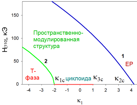
Рис. 1. Фазовая диаграмма (110)-пленки \text{BiFeO}_3 . \mathbf{H} \parallel [110] , k_1 = 4K_1A/\gamma^2 . 1,2 — линии СПФП второго рода.
