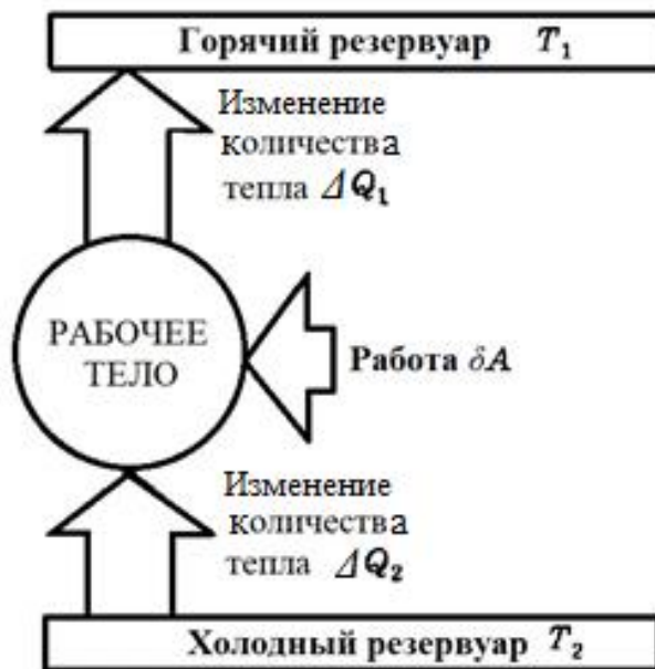
Рис. 1.4 Принцип действия холодильной машины – обратный цикл Карно. За термодинамический цикл над рабочим телом совершается работа \delta A , при этом количество теплоты \Delta Q_2 поступает от холодного резервуара к рабочему телу, а количество теплоты \Delta Q_1 передается от рабочего тела к горячему резервуару.
